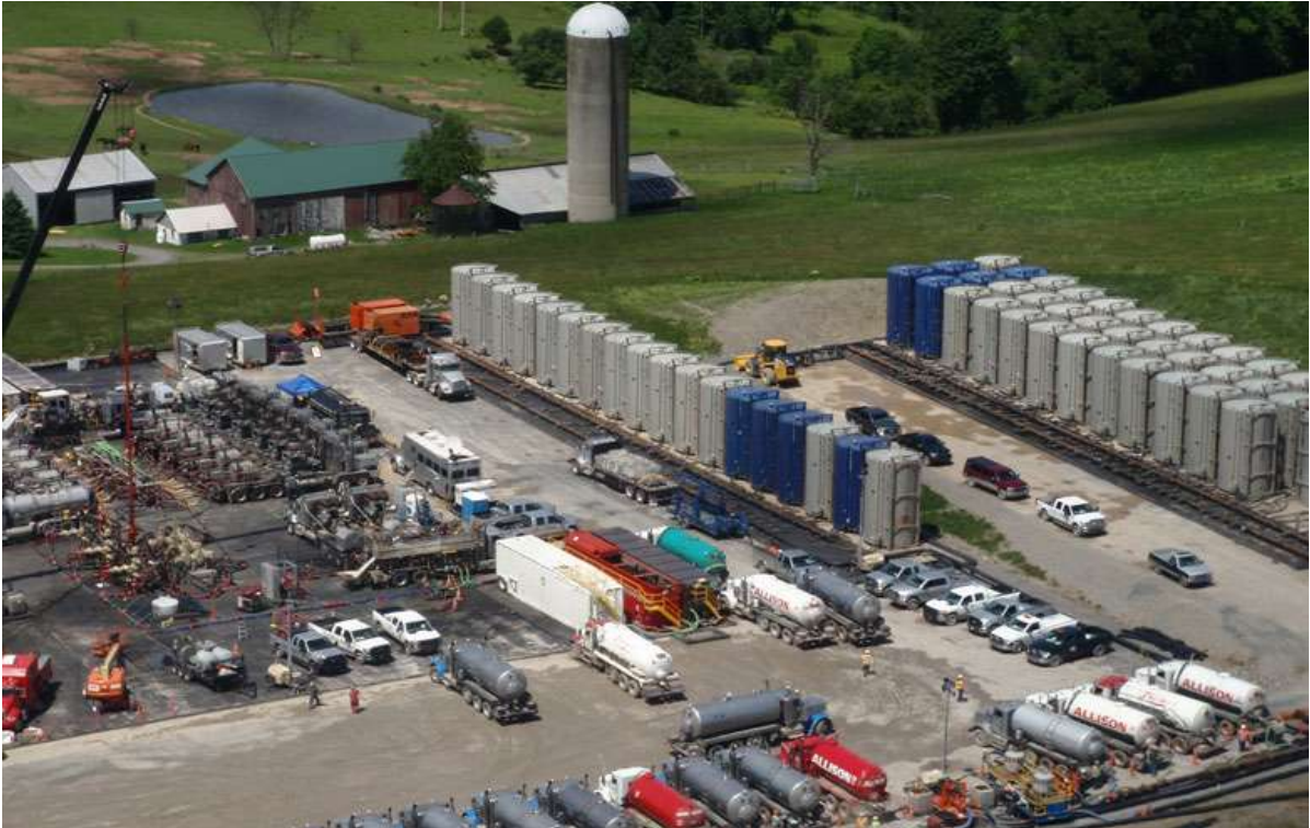
Figura No. 1 Espacio y equipos necesarios para fracturar un pozo en lutitas ( shales )
